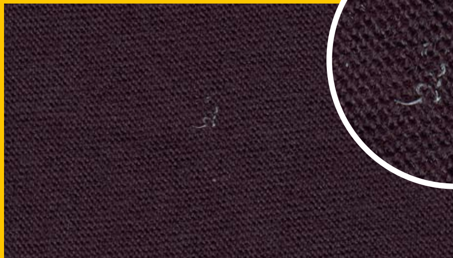
Defeito causado por fibras estranhas em artigos de malha
