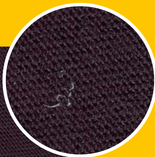
Defeito causado por fibras estranhas em artigos de malha
