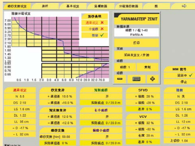
图8: YarnMaster®捻接头分级清除
