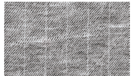
Abbildung 13: Maschenware mit +48% SFI/D-Abweichung
