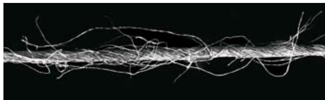
Figura 5: Fotografia microscópica de um fio com muita pilosidade
