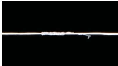
dTex 860: Defecto de estiramiento
