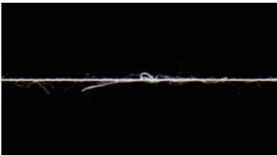
dTex 470: rottura di filamento
