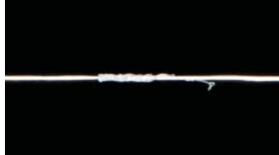
dTex 860: difetto di elasticità
